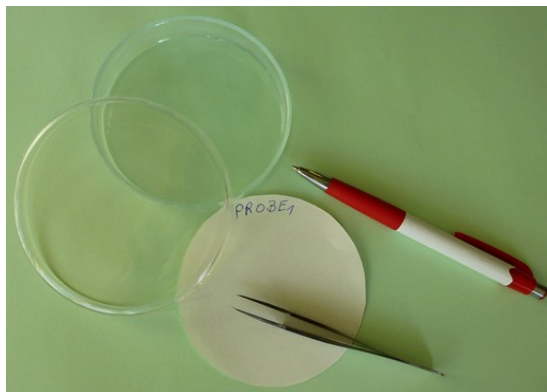
Abb. 8: Filterpapier mit wasserfestem Stift beschriften, dann anfeuchten und in die Petrischale legen
